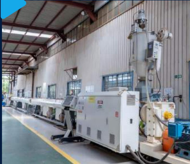
Ligne 4 : Extrudeuse & Aval 20 mm à 110 mm de diamètre extérieur
