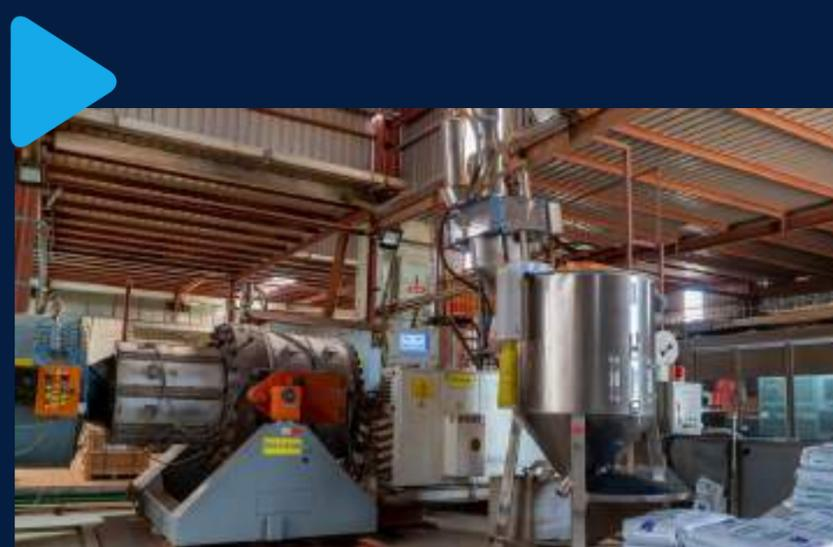
Ligne 1 : Extrudeuse 315 mm jusqu'à 900mm
