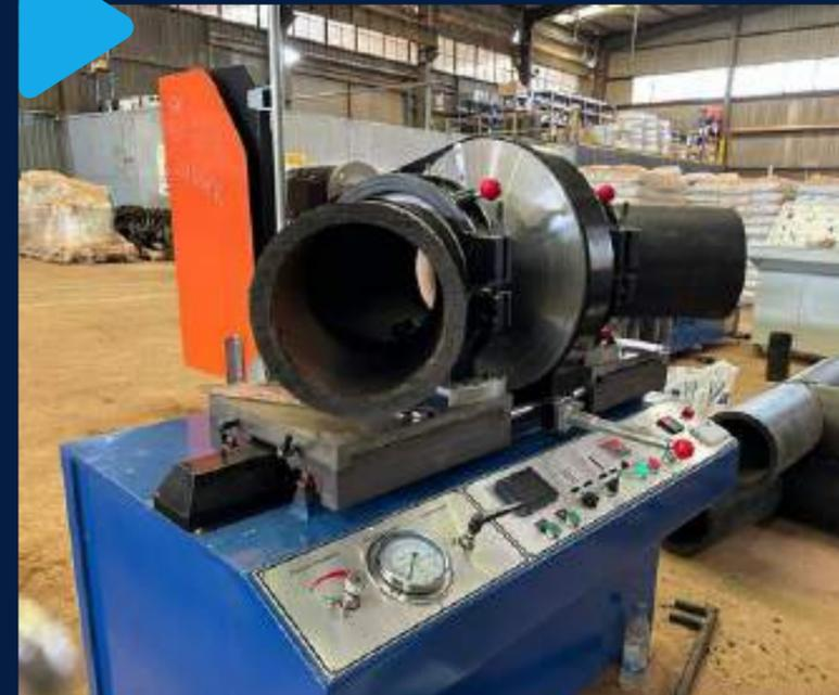
Machine de soudage à raccords multi-angles
