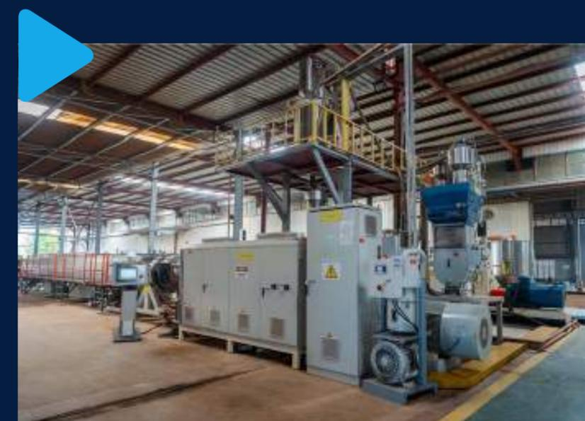
Ligne 2 : Extrudeuse 315 mm jusqu'à 630 mm
