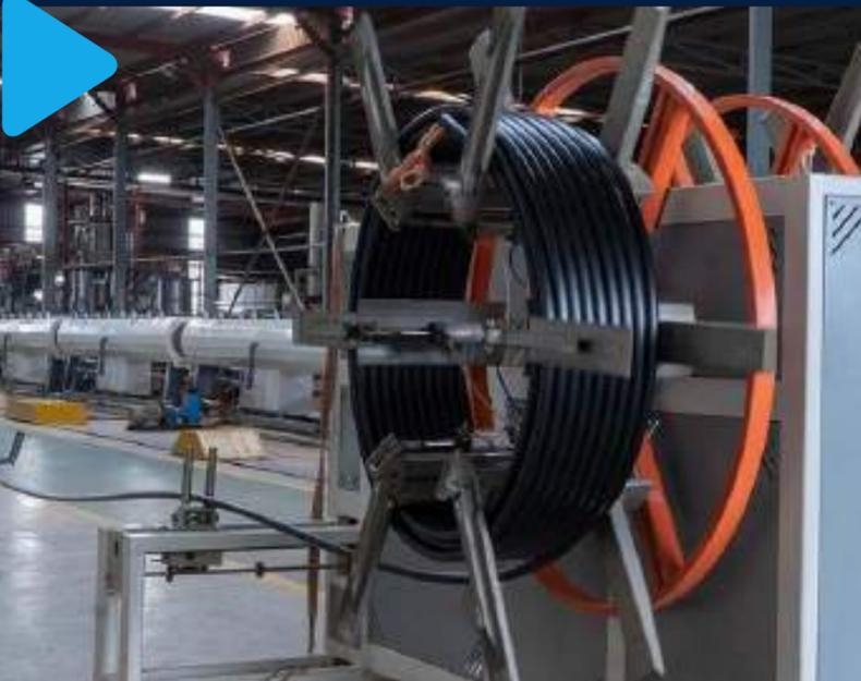
Enrouleur de tube double station -1 20 mm à 63 mm
