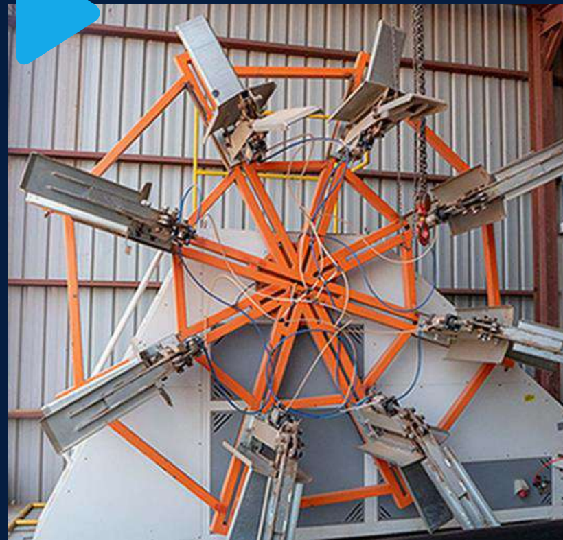
单工位绕管机-2 75毫米至110毫米
