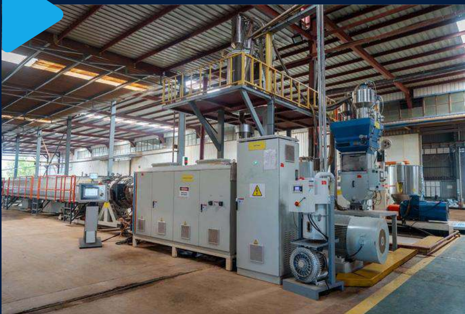
第2条生产线：挤出机 315 mm 至 630 mm
