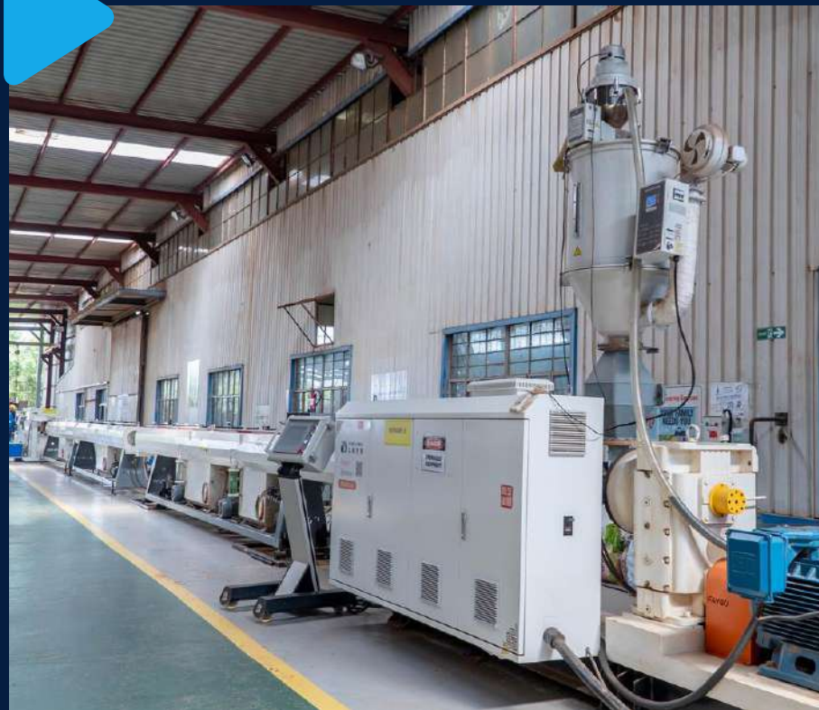
第4条生产线：挤出机和下游 20 毫米至 110 毫米外径
