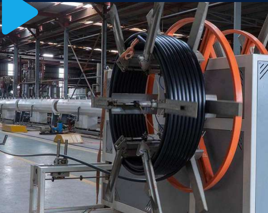
第4条生产线：挤出机和下游 20 毫米至 110 毫米外径
